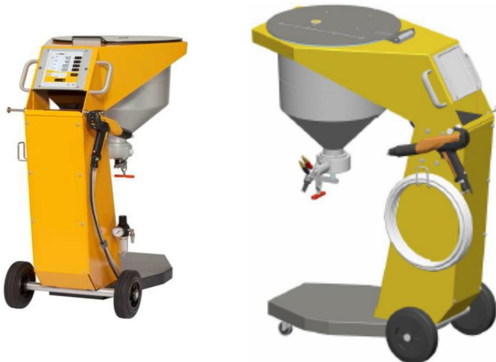
Новейшая и самая высокопроизводительная установка предназначена для электростатического напыления порошковых красок на металлические изделия практически любой конфигурации. Легко очищаемый резервуар емкостью 18 л облегчает работу со сложными порошковыми красками, типа металлики, структурированные и другие. Данный вид установок идеально подходит для быстрой смены цвета.
